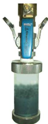
ある程度スラッジが沈殿したら取外します(詰まる可能性があるためカップ内に目一杯溜めず多くても八分目程度)
