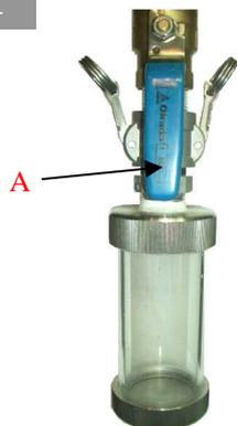
FILSTARドレンバルブが閉になっている事を確認して下さい(必要であればFILSTARへの供給を止めて下さい)
