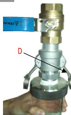
カップが落ちないように手で押さえ反対側のレバーも下へ引きます。(D)
