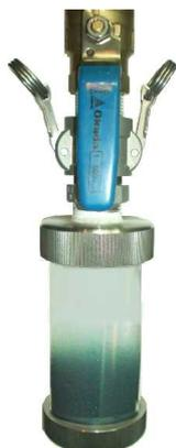
時間と共にカップ内にスラッジが沈殿してきます(サンプルにより沈殿時間が異なります)
