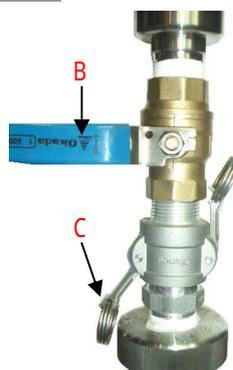
カップを取外には、まずFILSTARドレンバルブを閉にします。(B)
